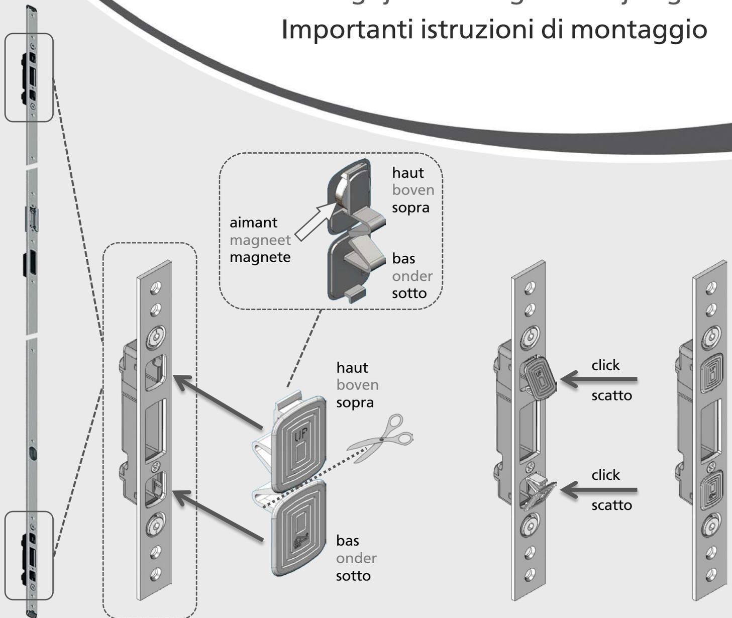
Pour l'utilisation des serrures automatiques **multisafe** 833/833P ou **autotronic** 834/834P, il est impératif de monter les caches des aimants comme indiqué sur le schéma.
